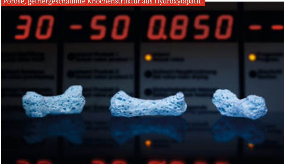
Poröse, gefriergeschäumte Knochenstruktur aus Hydroxylapatit.
